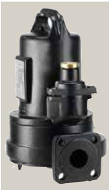
Die **Einbausets DN 40** sind zugeschnitten auf die Baureihen der **MultiCut-Schneiradpumpen** von Pentair Jung Pumpen. Es gibt sie in vielen verschiedenen Ausführungen mit Förderhöhen von 14,5 m bis hin zu 55 m. Allen gemeinsam ist das Schneidsystem, welches Feststoffe im Abwasser zerkleinert und so durch klein dimensionierte Druckleitungen mit hohem Druck über weite
